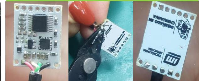
12.- CORTAR CABLE DEL OTRO EXTREMO Y QUITAR LA CUBIERTA DE LOS CABLES.
