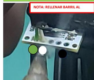
21.- INSERTAR CABLE NEGRO DOS ORIFICIOS DESPUES DEL CABLE BLANCO Y SOLDAR.
