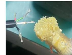
10.- INSERTAR CABLES EN ORIFICIOS DE TABLILLA CON AYUDA DE TWEEZERS Y SOLDAR.
